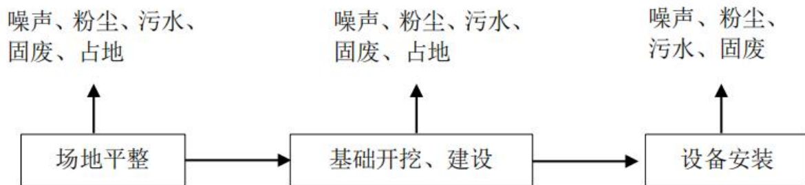
图 2-6 升压站施工期主要污染工序图
